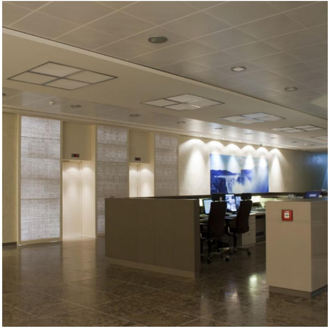
Als besonderes Highlight im Eingangsbereich sowie in den Vorstandsetagen wurde in der Hauptverwaltung der Signal Iduna, Dortmund eine transluzente Aufzugswandverkleidung mit LUCEM Lichtbeton ausgeführt.
