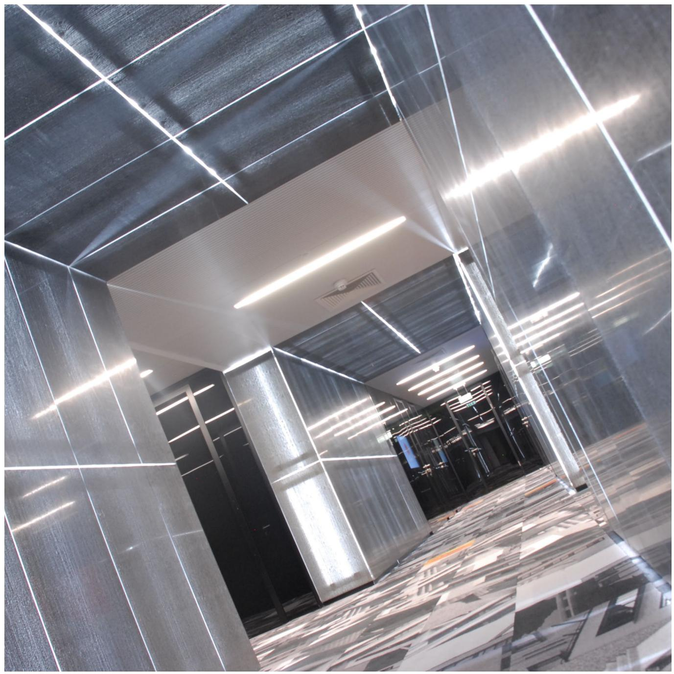
Im Zuge des Umbaus für die Bank of Georgia wurden ein begehbarer Kubus sowie Teile des Innenausbau und Wandverkleidungen in LUCEM Lichtbeton ausgeführt.
