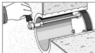
Muttern wechselweise über Kreuz anziehen. Maximales Drehmoment beachten.
